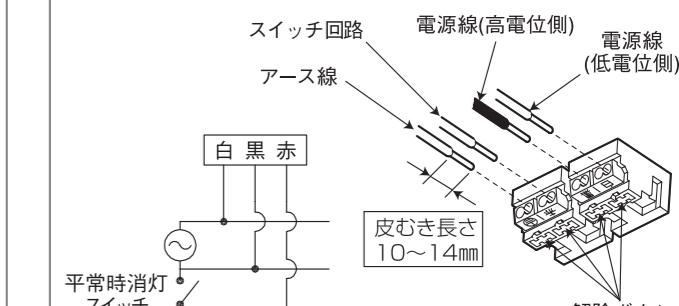
注) 電源線接続後、余分な電源線はライトユニットとの当たりを防ぐため、電源穴へ押し込むか、電源線を押しつけて処理してください。
